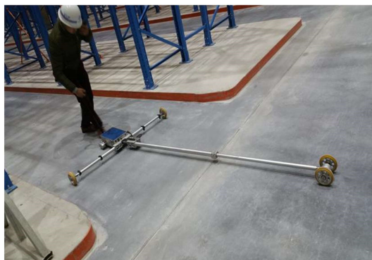
图4 现场数字曲线仪检测
