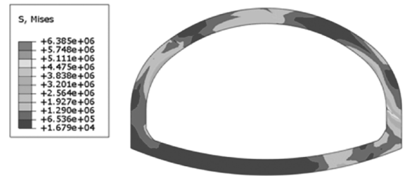
图3 原始地层状态隧道受力图(Pa)
