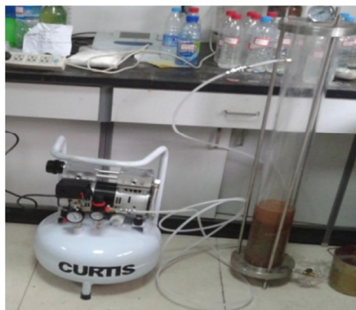
图2 泥浆渗透试验装置
