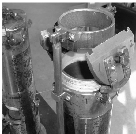
图 2 封闭式软土取样器
