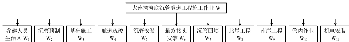
图2 大连湾海底沉管隧道工程分项工程分解
