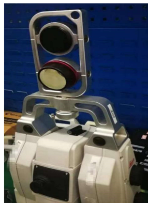
图 1 全站仪安装标靶棱镜效果图
