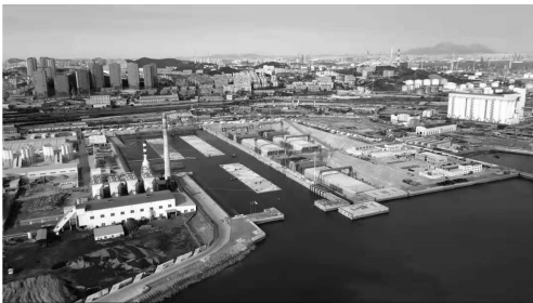
图 1 大连湾海底隧道干坞平面 Fig. 1 Plan of dry-dock for Dalian Bay Subsea Tunnel
